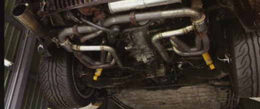
排気系はEXマニからマフラーまでガレージトータルで製作。パイプ径はEXマニが42.7φ×3→50φ、タービン後のマフラーがメイン80φ、テールエンド90φとなる。ちなみに、左右両出しだけマフラーのテールエンドは右側だけ。左側はウエストゲートの大気開放パイプだ。
