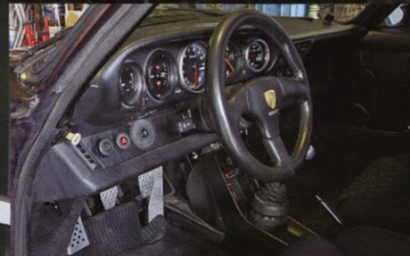
911の伝統といえる5連メーター。センターのタコメーターはデフィ1万1000rpmフルスケールタイプに交換され、もともとアナログ式の時計が入る右端にはブリッツブースト計が装着されている。
